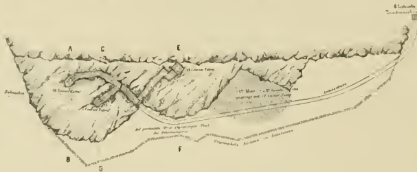
Abb. 76. Sprengung des Sprechenstein. [Brenner-Bahn.]
